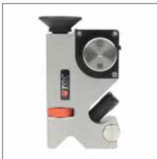
Superpig medidor destructivo de espesores de recubrimiento
